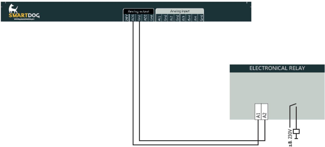
Verwenden Sie nur elektronische Relais (Art.Nr. 400010 – max. 230 V / 16 A oder Art.Nr. 400000 – max. 230 V / 6 A), ansonsten kann der Analogausgang zerstört werden
