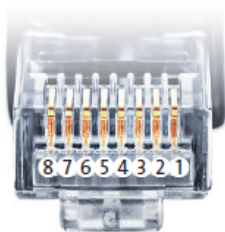
Belegung RJ45 Ethernet-Patchkabel
