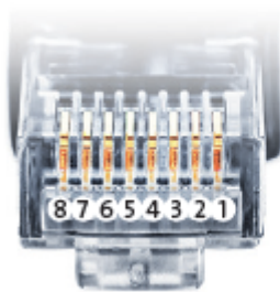
Belegung RJ45 Ethernet-Patchkabel
