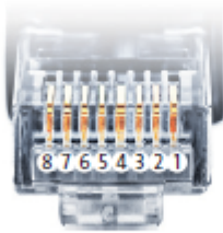
Belegung RJ45 Ethernet-Patchkabel
