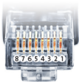
Belegung RJ45 Ethernet-Patchkabel
