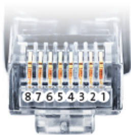
Belegung RJ45 Ethernet-Patchkabel
