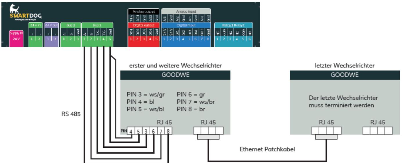
2. Kabel vom SmartDog zu Wechselrichter 1 durch die Kabeldurchführung an der Geräteunterseite führen. 3. Im Wechselrichter RJ45-Stecker in Buchse „RS-485 out“ stecken.
