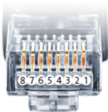
Belegung RJ45 Ethernet-Patchkabel
