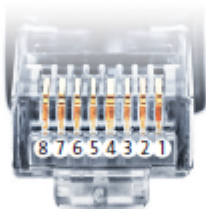
Belegung RJ45 Ethernet-Patchkabel
