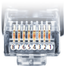
Belegung RJ45 Ethernet-Patchkabel
