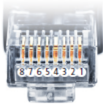
Belegung RJ45 Ethernet-Patchkabel
