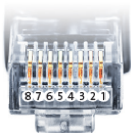
Belegung RJ45 Ethernet-Patchkabel
