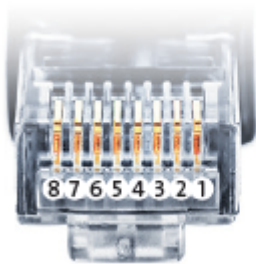
Belegung RJ45 Ethernet-Patchkabel
