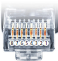
Belegung RJ45 Ethernet-Patchkabel
