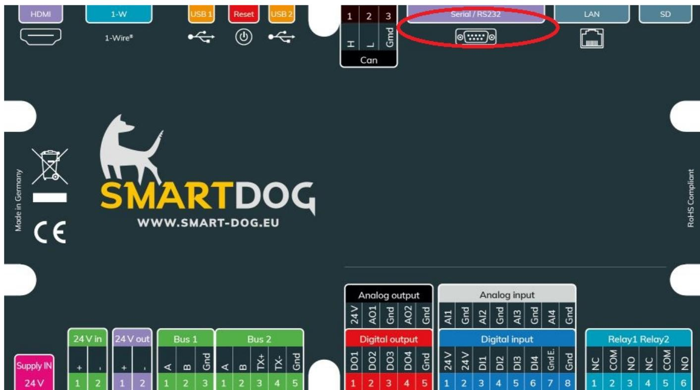
Hier können Sie einen Seriellen Anschluss verwenden oder mit einer Schnittstellenerweiterung [Artikelnummer 00000] einen weiteren RS485/422 BUS realisieren **Buskommunikation**
