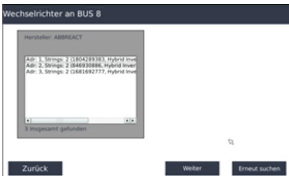
Wenn Sie sicher sind, dass alle Wechselrichter gefunden wurden, die angeschlossen sind, können Sie auch „Abbrechen“ drücken
