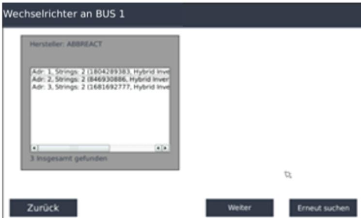
Wenn Sie sicher sind, dass alle Wechselrichter gefunden wurden, die angeschlossen sind, können Sie auch „Abbrechen“ drücken und müssen nicht warten bis der Suchlauf fertig ist
