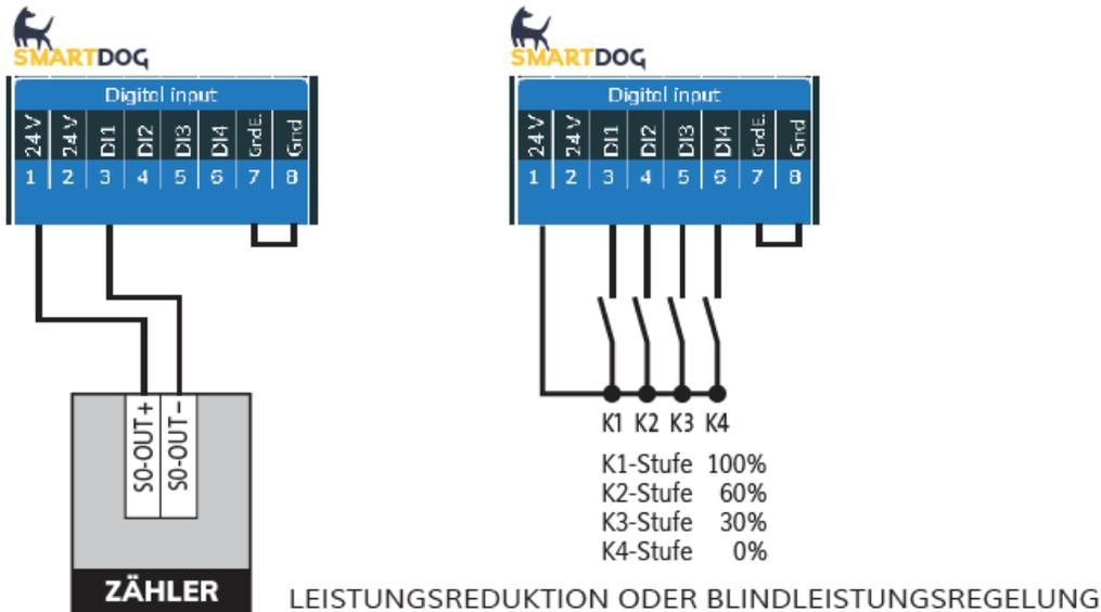
Die Reduktionsstufen werden vom Energieversorger vorgegeben und können am SmartDog® individuell für jeden Kontakt eingestellt werden. In der Regel ist der Kontakt für 100% am Rundsteuer-Empfänger nicht bestückt, da die Anlage ohnehin auf 100% hochgefahren wird, wenn kein Reduktionskontakt mehr ansteht
