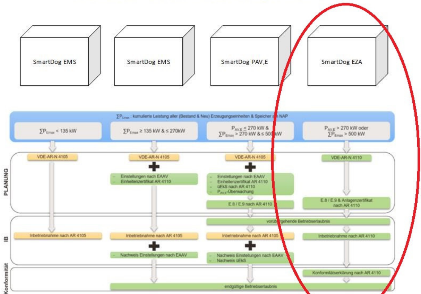
Bild 1: Vereinfachte Übersicht zu den wesentlichen Unterschieden des Anschluss- und Nachweisprozesses durch die NELEV-Novelle 2024 und die EAAV zu den bisherigen Prozessen nach den TAR
