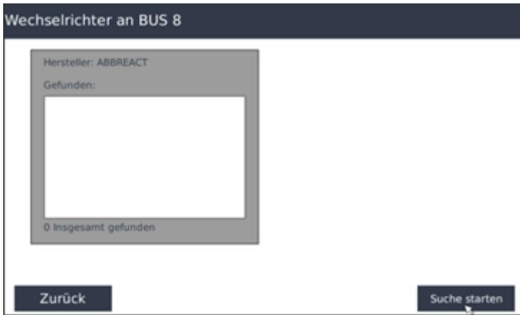
Mit „Suche starten“ können Sie die Wechselrichtersuche starten. Dabei wird der angegebene IP Bereich nach Wechselrichtern abgesucht
