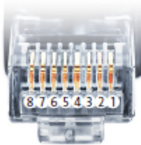
Belegung RJ45 Ethernet-Patchkabel
