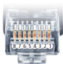
Belegung RJ45 Ethernet-Patchkabel
